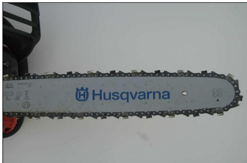
Tratándose de guía provistas de ranura, hay que procurar que ésta posea un ensanchamiento en la extremidad que se inserta en la máquina para facilitar la penetración en las mismas de los eslabones guías.
