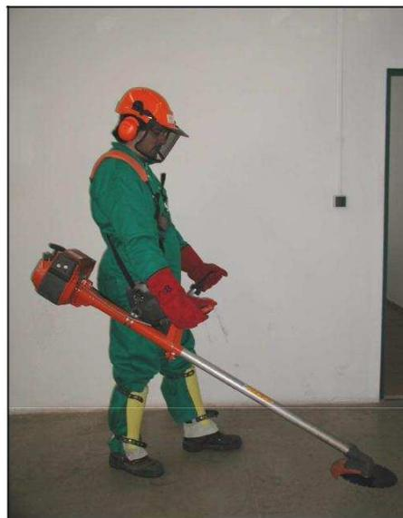
Se componen de un motor de dos tiempos, del mismo tipo que los de las motosierras (de las cuales, a veces no son sino una de las adaptaciones posibles), que transmiten por conducto de un embrague el movimiento a un árbol que gira en el interior de un tubo porta-herramienta que comunica la fuerza motriz a un órgano de corte.
