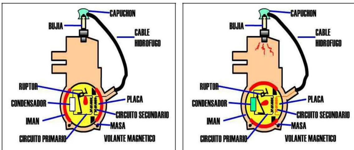
**Encendido electrónico.** En los encendidos electromagnéticos, el ruptor presenta una serie de problemas por desgaste y ajuste de los platinos, de difícil solución en el monte por el operario. Con la aplicación de la electrónica al sistema de encendido se sustituyen los platinos por un circuito electrónico que no tiene necesidad de piezas en movimiento, excepto el volante, evitando así el desgaste de los electrodos y manteniendo al mismo tiempo perfectamente a punto el encendido.
