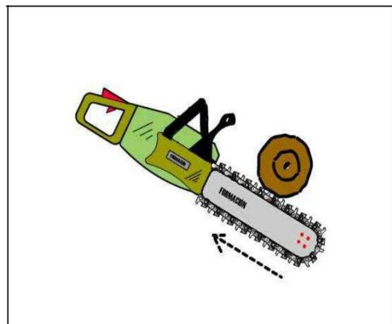
El corte con la punta de la barra se debe evitar ya que conlleva un alto riesgo ya que se puede producir un rebote.
