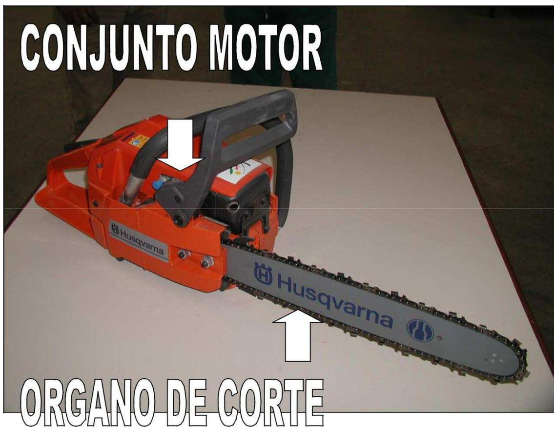
**Cilindros-Potencia.** Puede ser eléctrico, hidráulico o de explosión (cuatro o dos tiempos), si bien existe un franco predominio de estos últimos, ya que por su especial constitución pueden elegirse robustos y ligeros. Motor 2 tiempos: Funcionamiento.
