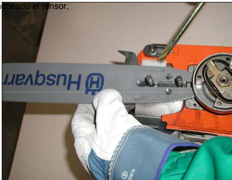
En algunos modelos el dispositivo de tensión va incorporado en la máquina.
